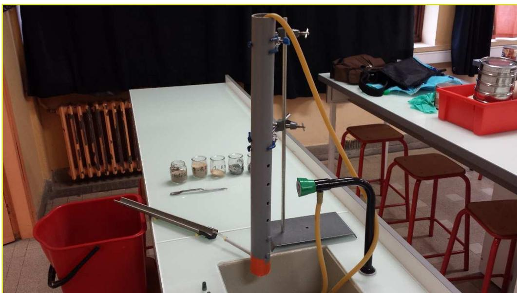
Un robinet alimente le cylindre en eau et des orifices jouent le rôle de trop plein. L'eau s'écoule dans un chenal puis se déverse dans un bac.
