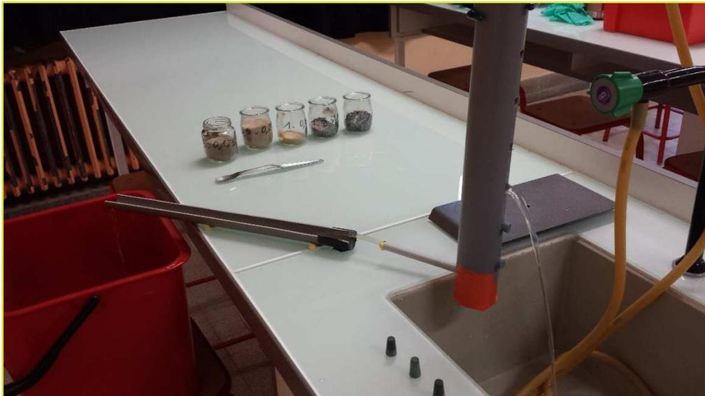
La hauteur d'eau dans le cylindre détermine la vitesse du courant au tube de sortie à la base du cylindre ( $v^2 = 2gh$ ).
